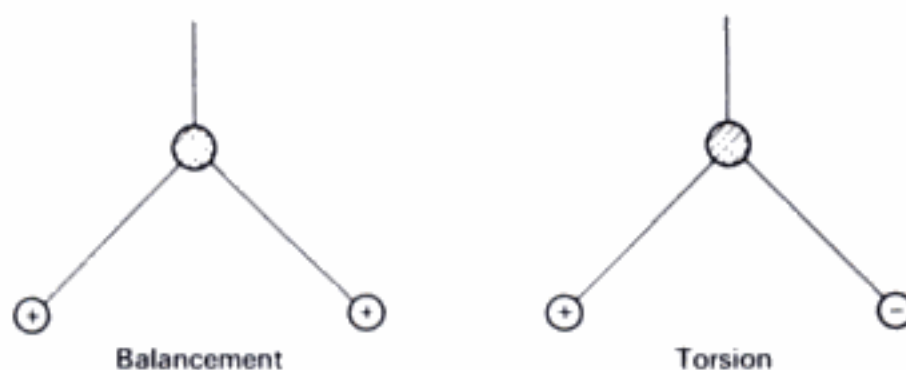
FIG. 20. — Vibrations hors du plan d'un groupement de 3 atomes, le signe + indique le mouvement vers l'avant (au-dessus du plan), le signe - indique un mouvement vers l'arrière (au-dessous du plan).
